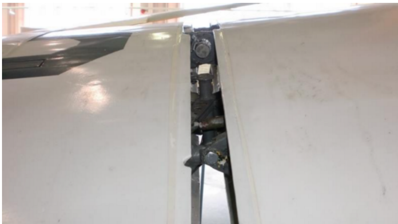
画像3 実機の中央翼と外翼の結合部
